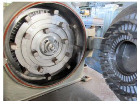
銘板の写し 銘板の写し 自由粉碎機(鉄製)
