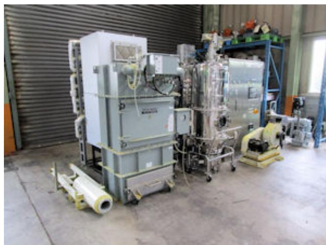
銘板の写し 銘板の写し 流動層造粒乾燥機
