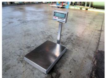
銘板の写し 銘板の写し 電気抵抗線式はかり
